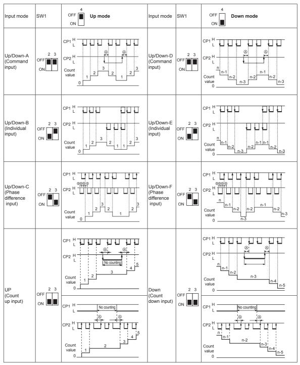
※(A): Over min. signal width, (B): Over 1/2 of min. signal width.
